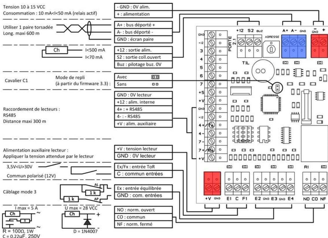
En mode de repli, le relais de commande est alimenté dès que le module est sous tension et le bus correctement raccordé à l'UTL.
